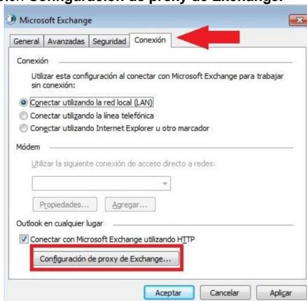
9. Complete el formulario donde indicando la URL del proxy para la conexión a Exchange posteriormente de clic en **Aceptar**.
